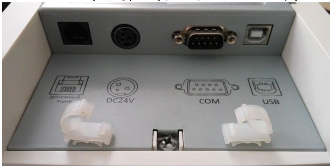
2. Подсоедините интерфейсный кабель (COM или USB) к разъему на задней поверхности ККТ.
